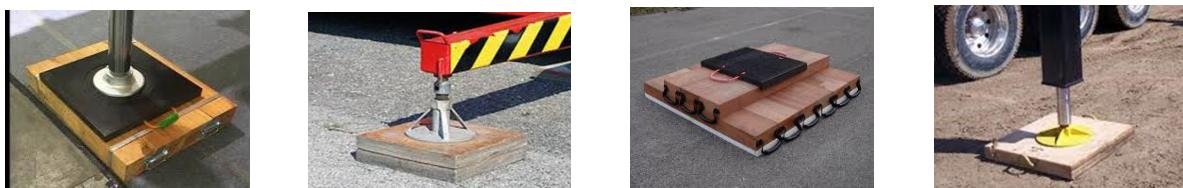
地面類型不同，地面的承重能力也不同。通常，硬地面（例如岩石）比軟地面（例如乾砂）承受的地面上壓力大。如果某地面是幾種地面類型的組合，則應使用較差的地面類型來確定將起重機安裝於支腿上時施加到地面上的最大地面壓力。
