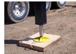
地面の種類が異なると、地面の耐荷重力も異なる。一般に、岩などの硬い地面は、乾いた砂などの柔らかい地面よりも高い接地圧に耐えることができる。地面の構成がさまざまな種類の組み合わせとなっている場合、アウトリガーを使用してクレーンを設置するときに地面に適用できる最大接地圧を判別するには、強度が弱いほうの地面の種類を採用する必要がある。
